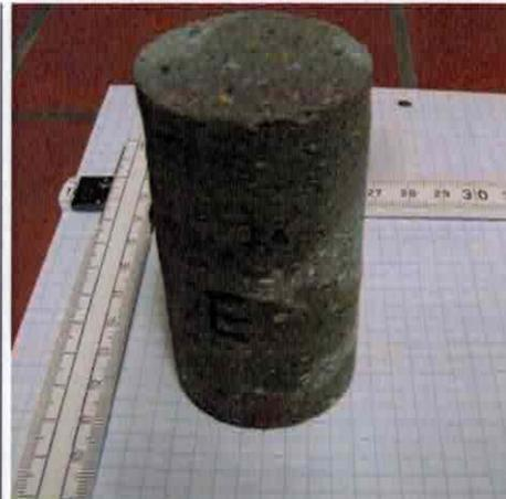
**B:** Wassergelagerter Probekörper
