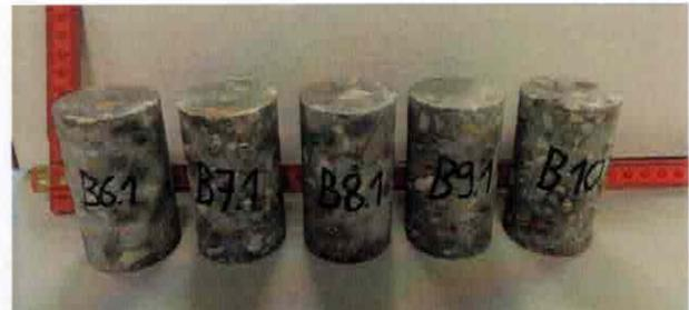
**B:** Zylindrische Probekörper aus dem Hochleistungsbeton SWHB
