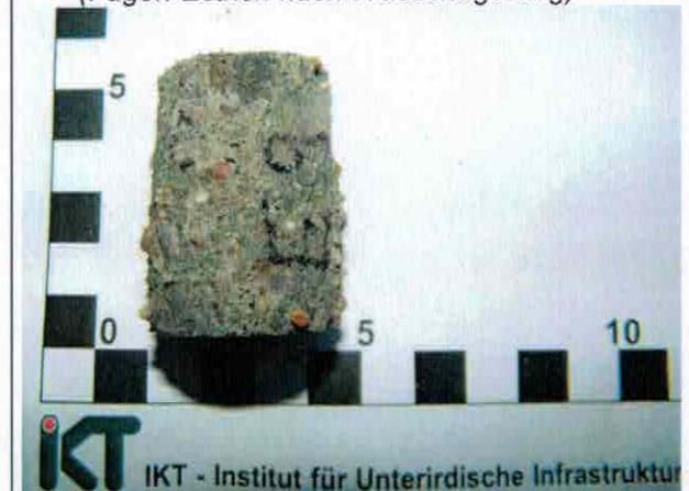
**D:** Probekörper für die Druckfestigkeitsprüfung (Fugen-Estrich nach Säurelagerung)
