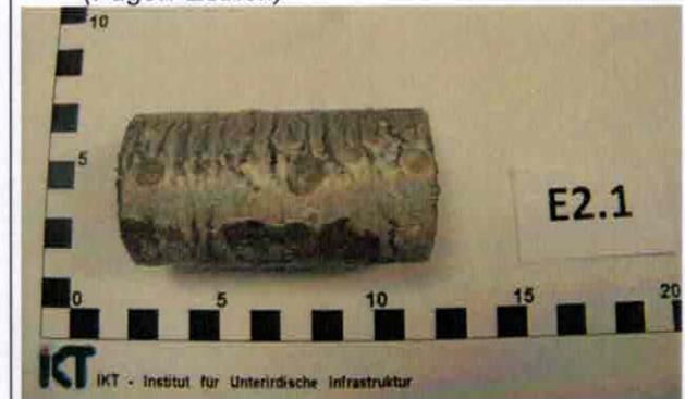
D: Probekörper (Fugen-Estrich) nach Entnahme aus Säurebad pH 1
