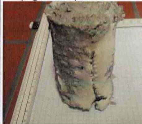
**D:** Probekörper (Fugen-Estrich)
