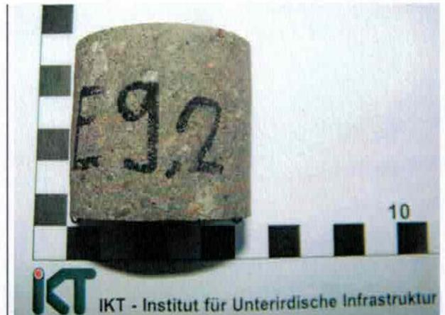
**C:** Probekörper für die Druckfestigkeitsprüfung (Fugen-Estrich nach Wasserlagerung)
