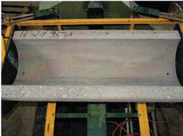
A: Rohrhalbschale aus Hochleistungsbeton SWHB
