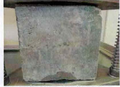
**C:** Probekörper 3 mit sichtbarem Feuchtheitsaustritt an der Außenseite nach ca. 2 min Prüfzeit
