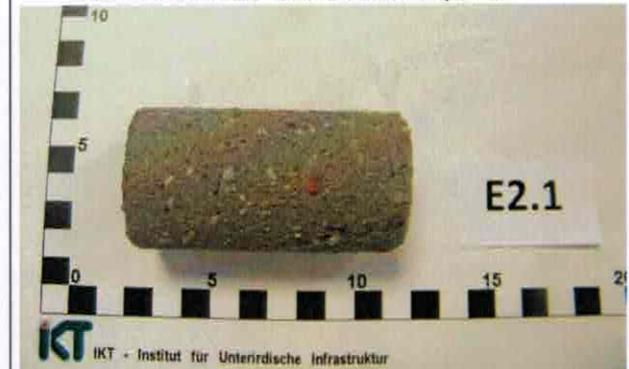
F: Abgebürsteter Probekörper (Fugen-Estrich)
