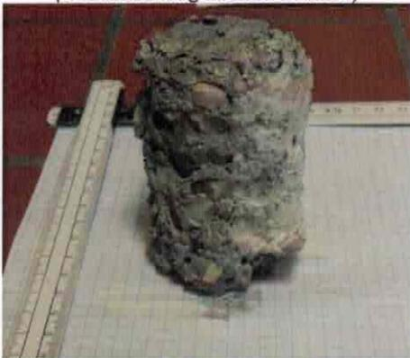
**C:** Probekörper (Hochleistungsbeton SWHB)
