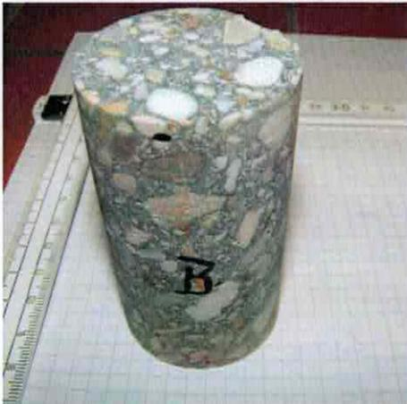
**A:** Wassergelagerter Probekörper
