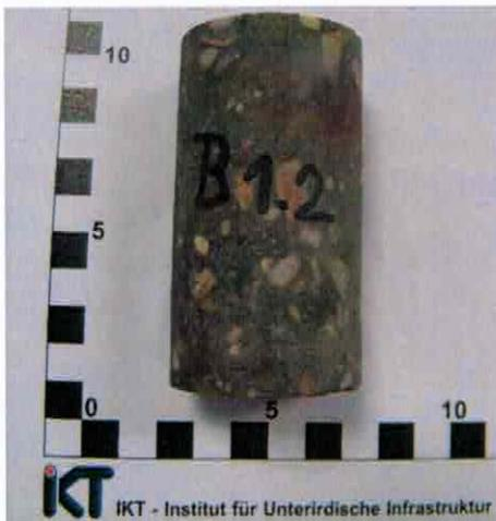
A: Wassergelagerter Probekörper (Hochleistungsbeton SWHB)
