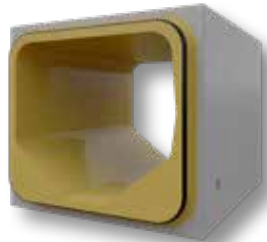
PMA Duoliner Rohrsystem mit Rechteckprofil und trapezförmiger Trockenwetterrinne
